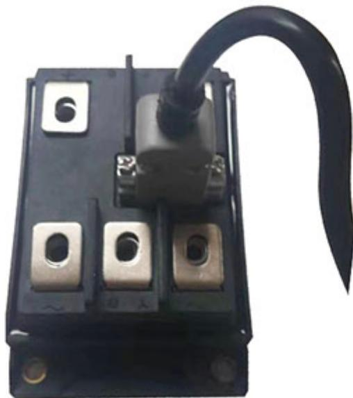
鉴别可控硅三个极的方法很简单，根据P-N结的原理，只要用万用表测量一下三个极之间的电阻值就可以。阳极与阴极之间的正向和反向电阻在几百千欧以上，阳极和控制极之间的正向和反向电阻在几百千欧以上（它们之间有两个P-N结，而且方向相反，因此阳极和控制极正反向都不通）。控制极与阴极之间是一个P-N结，因此它的正向电阻大约在几欧-几百欧的范围，反向电阻比正向电阻要大。可是控制极二极管特性是不太理想的，反向不是完全呈阻断状态的，可以有比较大的电流通过，因此，有时测得控制极反向电阻比较小，并不能说明控制极特性不好。另外，在测量控制极正反向电阻时，万用表应放在R\*10或R\*1挡，防止电压过高控制极反向击穿。若测得元件阴阳极正反向已短路，或阳极与控制极短路，或控制极与阴极反向短路，或控制极与阴极断路，说明元件已损坏。可控硅是可控硅整流元件的简称，是一种具有三个PN结的四层结构的大功率半导体器件。实际上，可控硅的功用不只是整流，它还可以用作无触点开关以快速接通或切断电路，实现将直流电变成交流电的逆变，将一种频率的交流电变成另一种频率的交流电，等等。可控硅和其它半导体器件一样，其有体积小、
